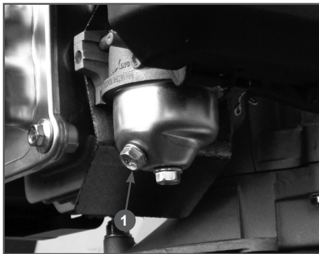
Рис. 19 Слив топлива из карбюратора
